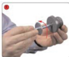
Dévisser l'écrou et le boulon des 2 embouts en plastic.
